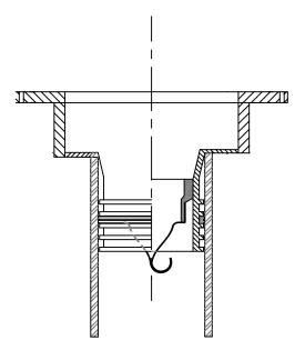
PART NO. TG36-IP 6" INSERT FITS INSIDE 6" CAST IRON OR PLASTIC PIPE
